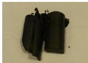
por lo que se lo debe pulverizar en forma mecánica a través de molino a rodillo (diseñado y construido a tal efecto).
