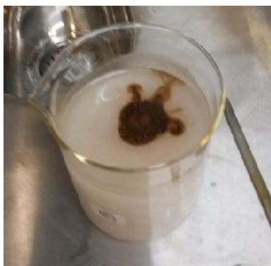
Establecidos los potenciales de reducción del hipoclorito de sodio, y de oxidación del manganeso desde su forma de hidróxido de manganeso II precipitado a bióxido de manganeso se define como pH óptimo para la reacción el de 9, estableciendo una diferencia de potenciales considerable como para que la reacción ocurra rápidamente,
